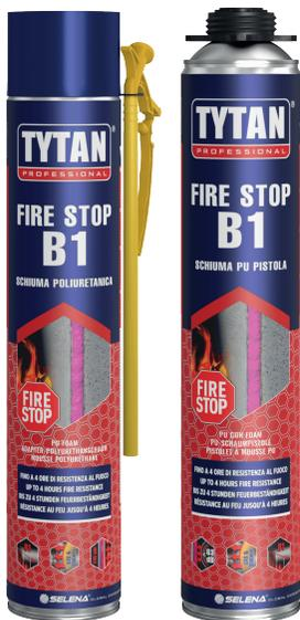
Schiuma poliuretana resistente al fuoco in classe B1 EI240. È una schiuma di alta qualità, certificata per resistere in applicazioni REI fino a 240 minuti. Formulata per tutte le applicazioni dove è necessario creare compartimentazioni ignifughe. Ideale nella posa di serramenti tagliafuoco e come fondo giunto in applicazioni REI.
