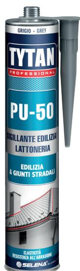
Tytan Professional PU 50 Edilizia/Lattoneria è un sigillante/adesivo poliuretano monocomponente medio modulo che polimerizza a temperatura ambiente a contatto con l'umidità atmosferica. Flessibile e resistente è raccomandato per sigillature, incollaggi e fessurazioni in lavori di edilizia generale e costruzioni stradali. Particolarmente adatto per giunti di lattoneria, pavimentazioni, automobili, contenitori, silos, sistemi di raffreddamento e di ventilazione.
