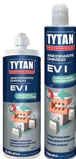
Tytan Professional EV I è un sistema di ancoraggio chimico di resina poliestere senza stirene ad alte prestazioni, di rapido indurimento, bicomponente. Viene estruso, attraverso gli appositi miscelatori, direttamente all'interno dei fori di fissaggio. Dopo l'indurimento la resina produrrà un'affidabile ancoraggio.
