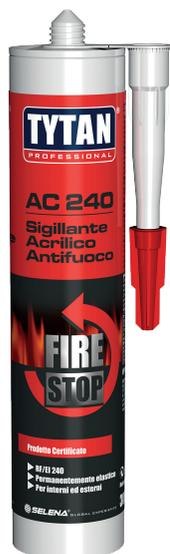
Tytan Professional Sigillante Antifuoco AC240 è un sigillante monocomponente a base di resine acriliche in dispersione acquosa. Polimerizza a temperatura ambiente ed è resistente al fuoco. Plastoelastico, non trasmette tensioni al giunto in parete. Resistenza al fuoco fino a 4 ore (secondo la norma UNI-EN-1366-4).
