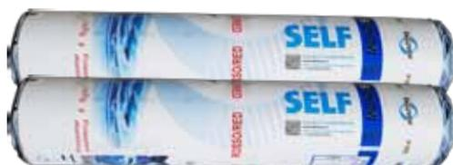
Membrane autoadesive realizzate con compound a base bitume modificato con polimeri elastomerici (SBS) per le MONOSELF o elastoplastomerici per le MONOSELF FV. L'armatura è costituita da poliestere rinforzato con tessuto di vetro. La faccia inferiore è rivestita con una massa speciale adesiva che assicura proprietà adesive.
