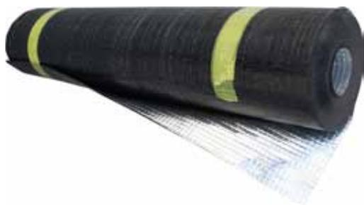
Membrana impermeabile ottenuta da un copound di bitume ossidato modificato fillerizzato, rivestita da una lamina di alluminio dello spessore di 80 um. Con speciale goffratura.
