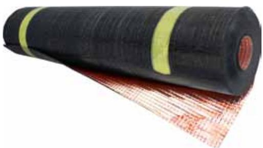
Membrana impermeabile ottenuta da un copound di bitume ossidato modificato fillerizzato, rivestita da una lamina di rame dello spessore di 80 um. Con speciale goffratura.
