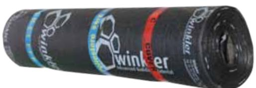
Membrana bitume polimero plastomero additivato con antivegetativo "PREVENTOL®" BAYER classe di flessibilità -10 °C. Armata con TNT poliestere a filo continuo (BPP 1100 32 Sec. UNI 8818) - (STAGIONALE)
